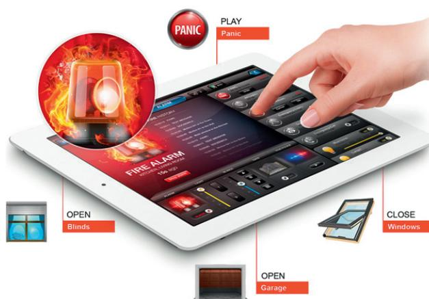
**Bild 5.101** Bei einem Brandalarm können Geräte dank Broadcast auch ohne definierte Szenen Aktionen ausführen (© Fibar Group).
